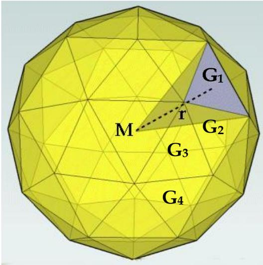
Das Volumen der Kugel ergibt sich näherungsweise aus der Summe der Pyramiden, die  $G_1, G_2, G_3, G_4, \dots$  als Grundflächen und M als Spitze haben. Die Höhe all dieser Pyramiden ist näherungsweise der Kugelradius  $r$ . Daraus folgt:
