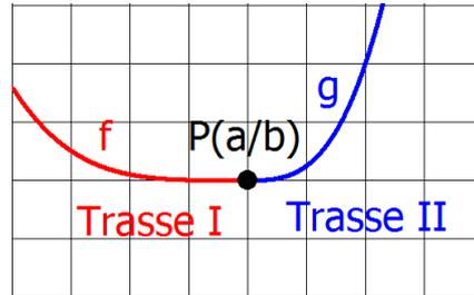
Zusätzlich fordert man, dass sich im Punkt P kein Steigungssprung ergeben soll, damit das Lenkrad nicht plötzlich „herumgerissen“ werden muss. Die beiden sich treffenden Kurven sollen also im Übergangspunkt P die gleiche Steigung besitzen. Übergänge, die im Übergangspunkt die gleiche Steigung haben, nennt man **knickfrei** (oder **glatt** bzw. **differenzierbar**).
