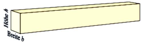
Die **Tragfähigkeit des Balkens** ist proportional zu seiner **Breite  $b$**  und zum **Quadrat seiner Höhe  $h$** . Seine Tragfähigkeit kann deshalb durch den Term  $T(b, h) = b \cdot h^2$  beschrieben werden.<sup>14</sup>
